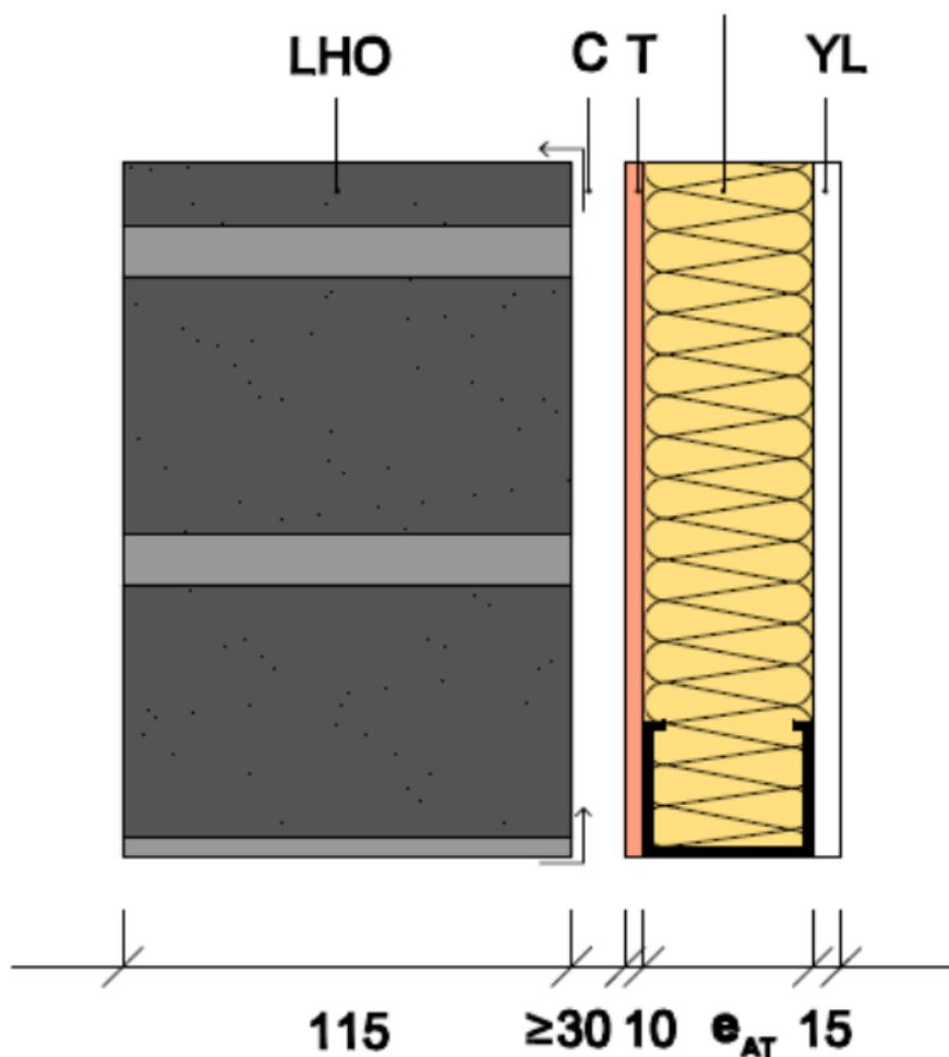
LHO: fábrica de ladrillo perforado de hormigón.
