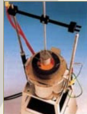
Bomba calorimétrica (A2)
