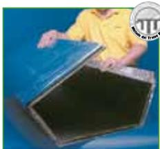
Conductos para distribución de aire. Acústica, limpieza interior y seguridad contra el fuego. Panel de lana de vidrio de alta densidad, revestido con aluminio reforzado por el exterior, y tejido **neto** por el interior.
