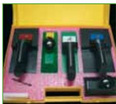
Realización de conductos **CLIMAVER**. Juego de cinco herramientas, para el corte de paneles **CLIMAVER**. Realizan el corte en media madera que aumenta la rigidez y calidad de los conductos contruidos; y los cortes en los tramos rectos, para fabricación de figuras según el Método del Tramo Recto.
