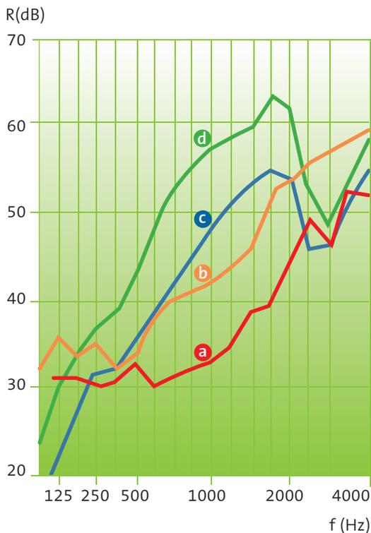
Si realizamos un análisis de frecuencias de un sistema de doble hoja nos encontramos con dos puntos característicos:
