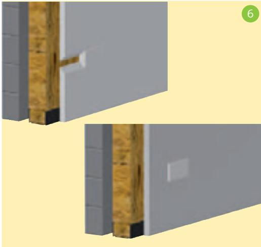
8. En caso de particiones verticales compuestas por hojas de fábrica, se recomienda utilizar bandas elásticas en elementos de separación de fábrica que tengan un ancho de al menos 4 cm superior al espesor de la hoja de fábrica:
