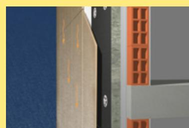
5. La estructura externa de la fachada ventilada aisla el edificio contra las inclemencias externas como el viento o la lluvia.
