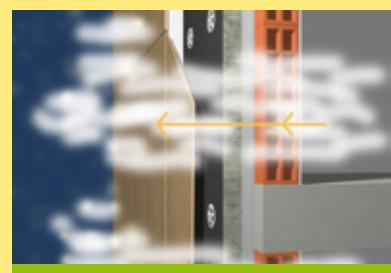
4. Ausencia de riesgos de compensación en la fachada (circulación de aire a lo largo de la cámara ventilada)
