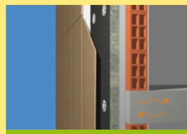
3. Evitar los puentes térmicos aplicando el aislamiento de forma continua.
