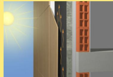
1. Conducir hacia el exterior el calor radiante.
