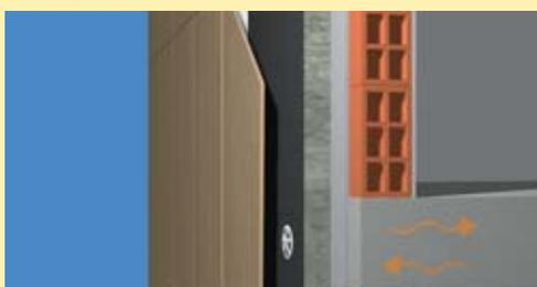
3. Evitar los puentes térmicos aplicando el aislamiento de forma continua.
