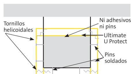
Para facilitar el trabajo de montaje del aislamiento, los productos U Protect se presentan en forma de paneles, como las soluciones convencionales presentes en el mercado sino también en formato mantas para los conductos circulares. Estas mantas están reforzadas con una malla de acero galvanizado para simplificar el sellado del aislamiento.
