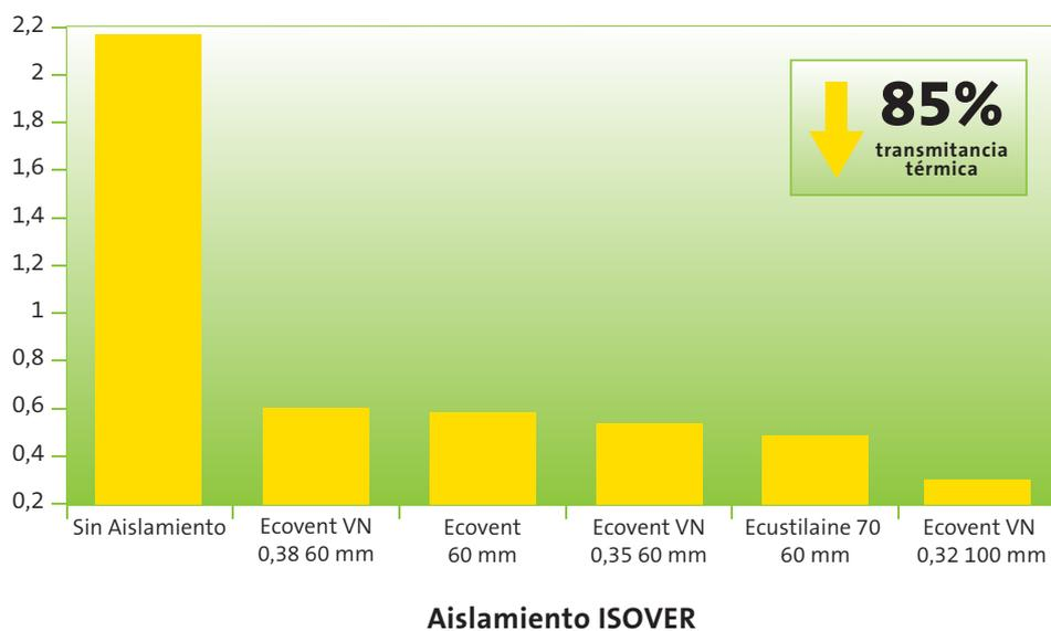
Vemos que con la utilización de los productos ISOVER diseñados específicamente para una fachada ventilada, la mejora en el valor de la transmitancia térmica del cerramiento son superiores al 85 % dependiendo del producto elegido y del espesor del mismo. Para minimizar las pérdidas energéticas deberemos de elegir materiales con baja conductividad térmica y alto espesor:
