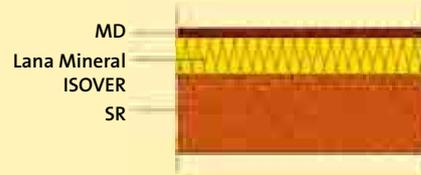
Sobre un soporte resistente o forjado se dispone la capa de lana mineral **ISOVER**, como aislante acústico, y un acabado de tablero de madera en la cara más superficial.
