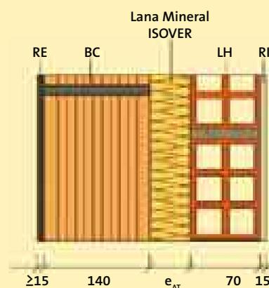
La hoja exterior es de fábrica de bloque cerámico acompañado de un revestimiento exterior continuo. Mientras que la interior se compone de una capa de fábrica de ladrillo hueco con un revestimiento interno que puede ser un enlucido, enfoscado o alicatado; todo ello conforma un bloque al que se encuentra unida una capa de lana mineral ISOVER. Las dos hojas se disponen unidas sin que exista ningún tipo de separación ni lámina intermedia.
