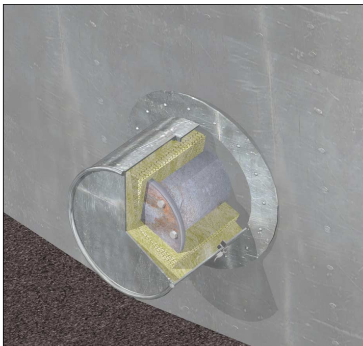
Figura 4: Aislamiento del registro de un tanque.
