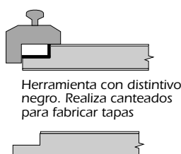
Herramienta con distintivo rojo. Corta a media madera para plegar el panel a 90°
