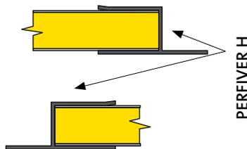
*El perfil **PERFIVER H** no es de uso exclusivo al Sistema **CLIMAVER METAL**, sino que tiene aplicación para realización de puertas de acceso y conexiones a máquina.*
