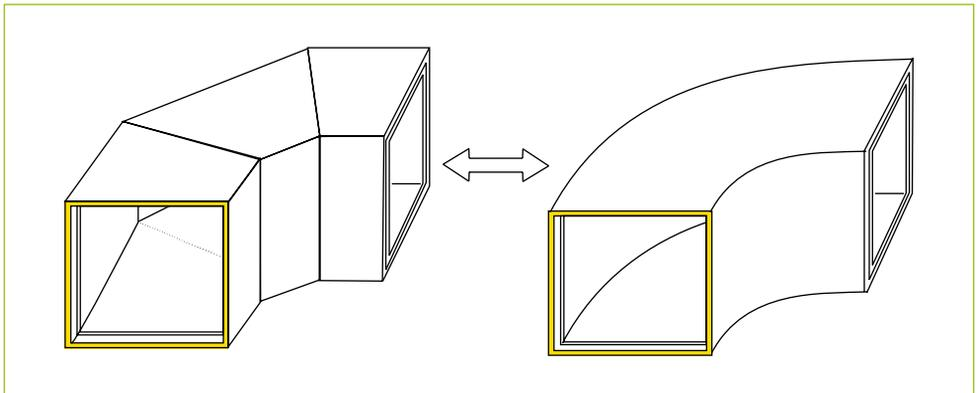
*Los conductos para aire acondicionado realizados con paneles de lana de vidrio presentan, en codos y ramificaciones, pérdidas de carga ligeramente inferiores, o a lo sumo similares, al realizarse en tramos rectos frente a la realización a través de tramos curvos.*
