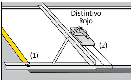
2. Se colocará la Regla-eskuadra **CLIMAVER MM** con la medida b del otro lado de la sección interna del conducto a obtener a partir del corte situado más a la derecha realizado por la herramienta de distintivo ROJO que se acaba de emplear (3). En dicha medida, se pasará la herramienta **CLIMAVER MM** con distintivo ROJO (4).
