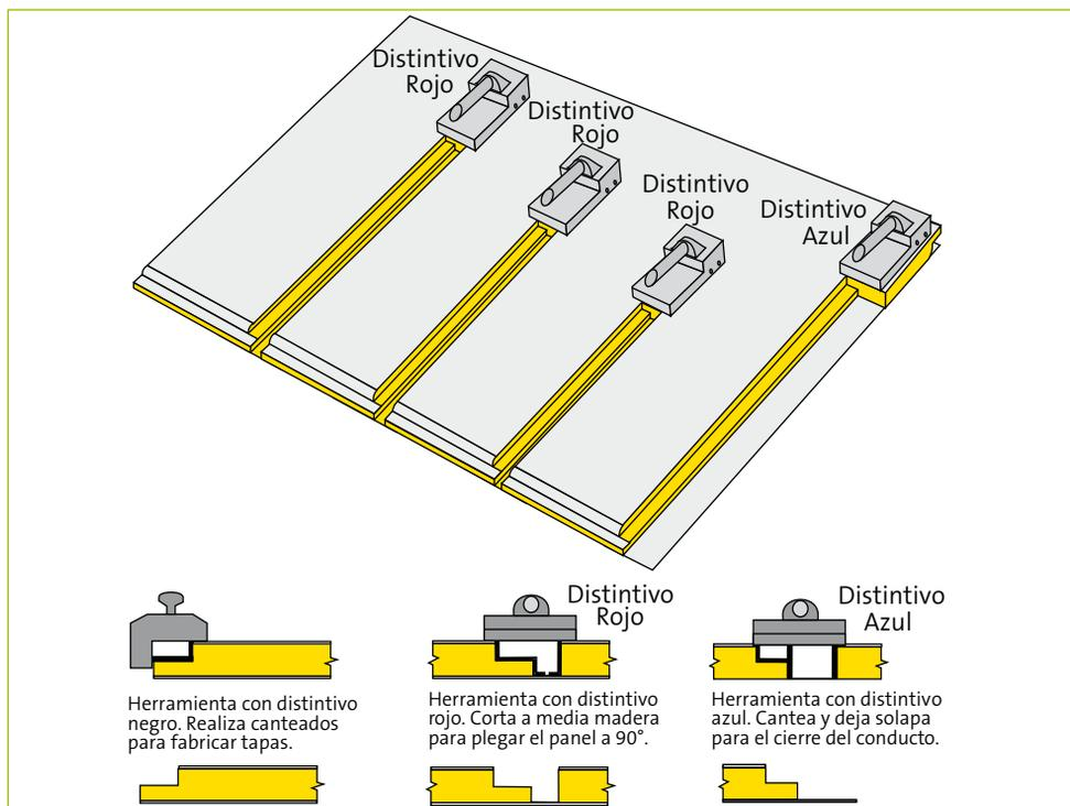
Las herramientas se componen de un soporte al que van atornilladas las cuchillas. Las Herramientas **CLIMAVER MM** llevan incorporado un dispositivo que simultáneamente corta el panel y facilita la separación del recorte sobrante.
