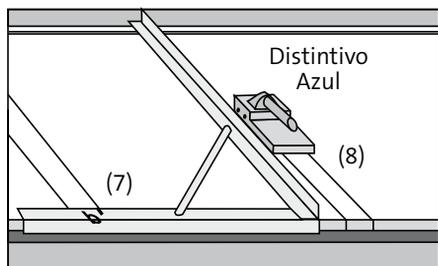
La unión de los extremos del panel para conformar el tramo recto debe realizarse, doblando el panel por las zonas cortadas formando una sección rectangular de conducto inclinada, es decir forzando el conducto con ángulos ligeramente menores al deseado ( $90^\circ$ ) para que la unión quede tirante y fuerte. Uno de los extremos del panel llevará una prolongación del revestimiento exterior que se grapará superpuesto al otro extremo.
