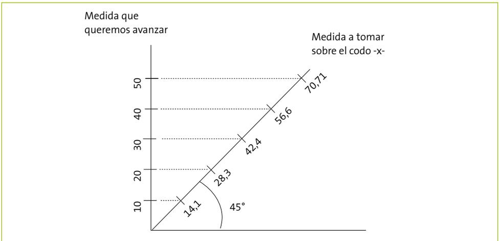
De esta forma, y mediante medición directa, obtenemos las medidas exactas para ajustarnos al diseño de la instalación.
