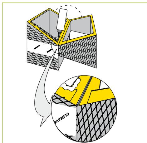
El sellado se obtiene aplicando un cordón de Cola **CLIMAVER** sobre la superficie de lana de vidrio de una de las piezas a unir, junto al borde del revestimiento interior y completando el perímetro interior de la sección.
