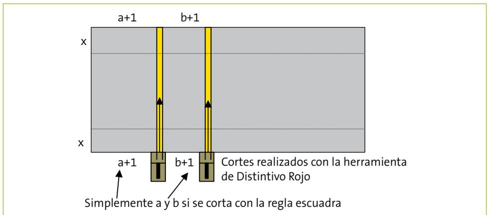
En la tapa 4 realizaremos un tajo interior en un lado y uno exterior en el otro. Esta tapa normalmente quedará mas corta que las otras tres, puesto que el recorrido es mayor, para subsanar esto, simplemente cortaremos el sobrante de las demás.
