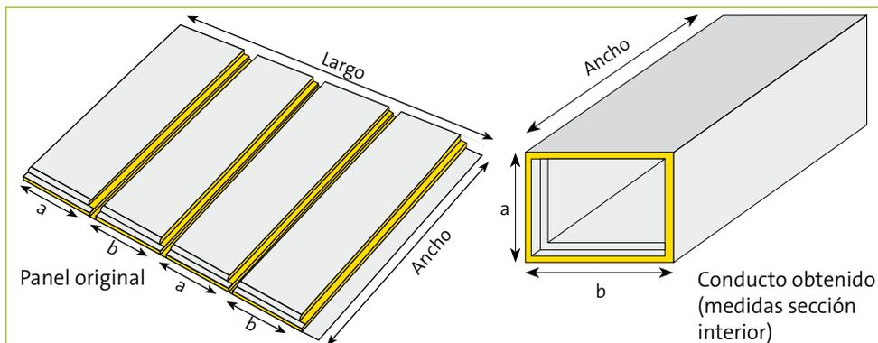
*El **CLIMAVER neto PRO**, panel preconformado a las medidas del conducto final, presenta ya las ranuras necesarias para doblar el panel a 90° y realizar el conducto directamente.*
