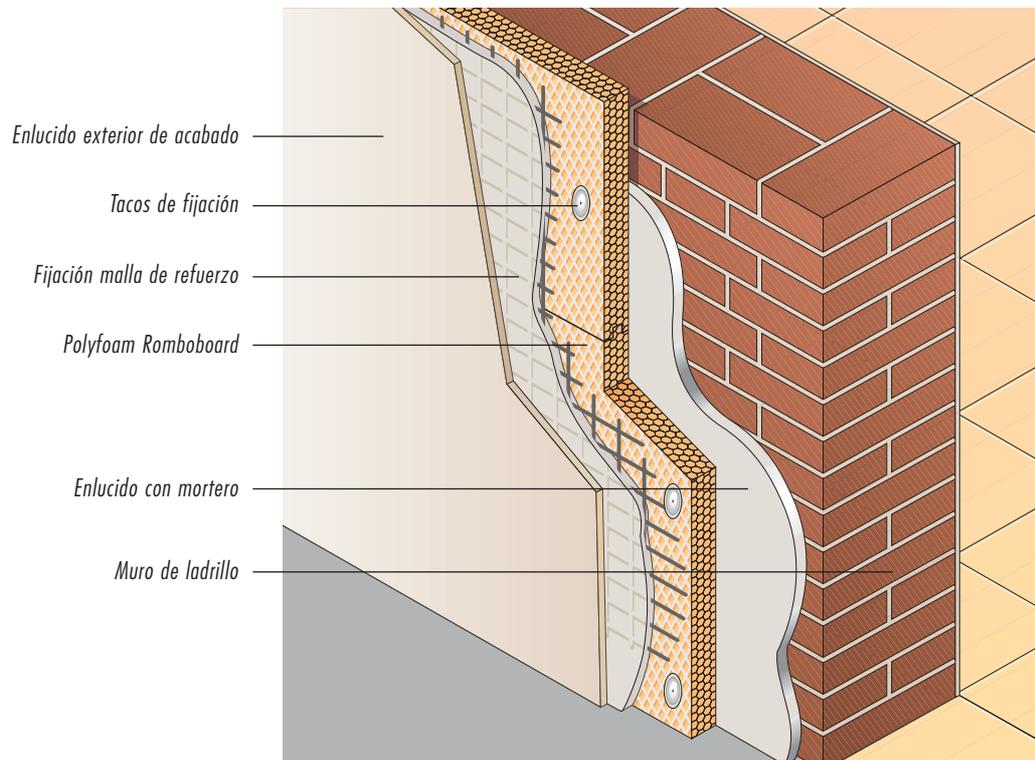
Fig. 1 - Aislamiento de muros por el exterior
