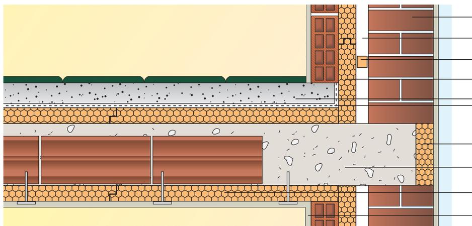
Fig. 3 - Aislamiento de muros con cámara
