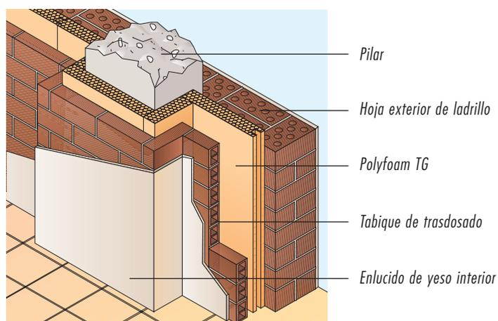
Fig. 4 - Detalle de aislamiento de un pilar
