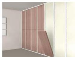
3 – Colocación de la Lana Mineral Natural Ultracoustic insertada en la estructura.
