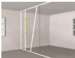
1 – Replanteo, colocación y fijación mecánica de estructura de entramado autoportante, a base de canales horizontales inferior y superior y montantes verticales separados 40 ó 60 cm.
