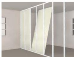
2 – Colocación de placas de yeso laminar para cierre de una de las caras del tabique, mediante fijaciones mecánicas.
