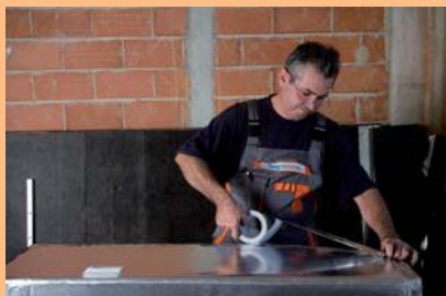
Encintado de la pieza de conducto obtenida a partir de un panel CLIMACOUSTIC
