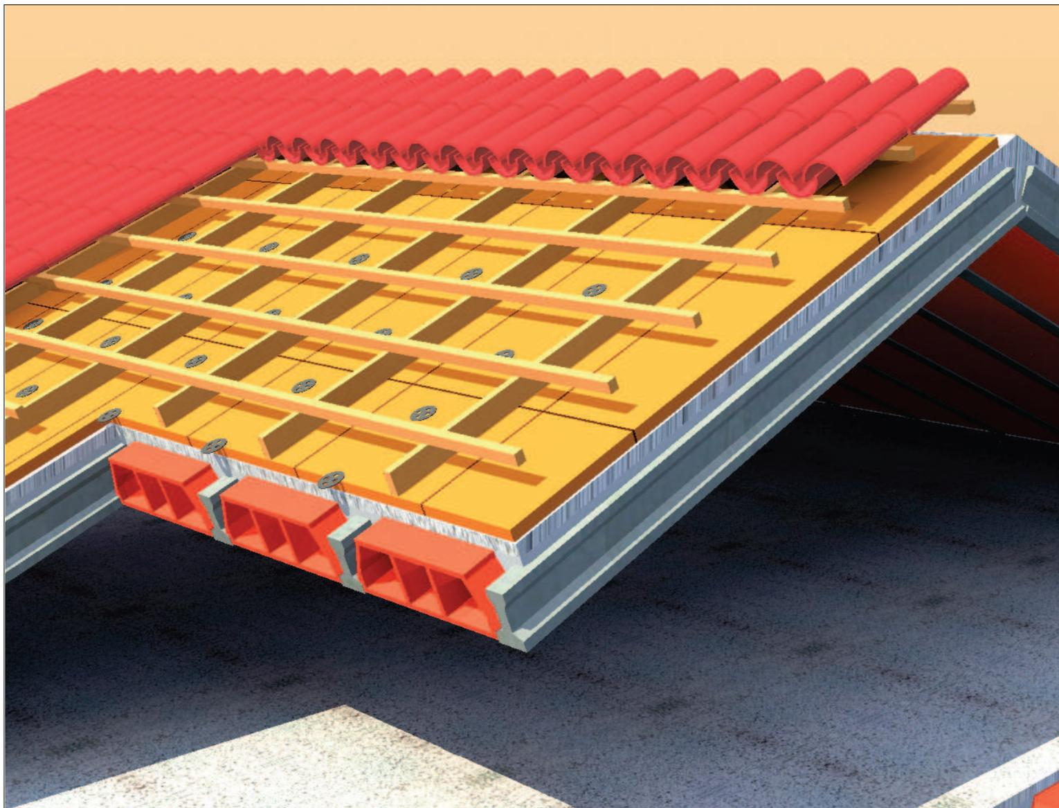
CUBIERTA INCLINADA CON POLYFOAM C4 LJ 1250 Y COBERTURA CLAVADA
