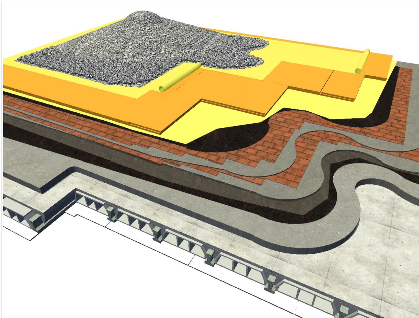
**AISLAMIENTO EXTERIOR DE CUBIERTA PLANA CON POLYFOAM C4 LJ**
