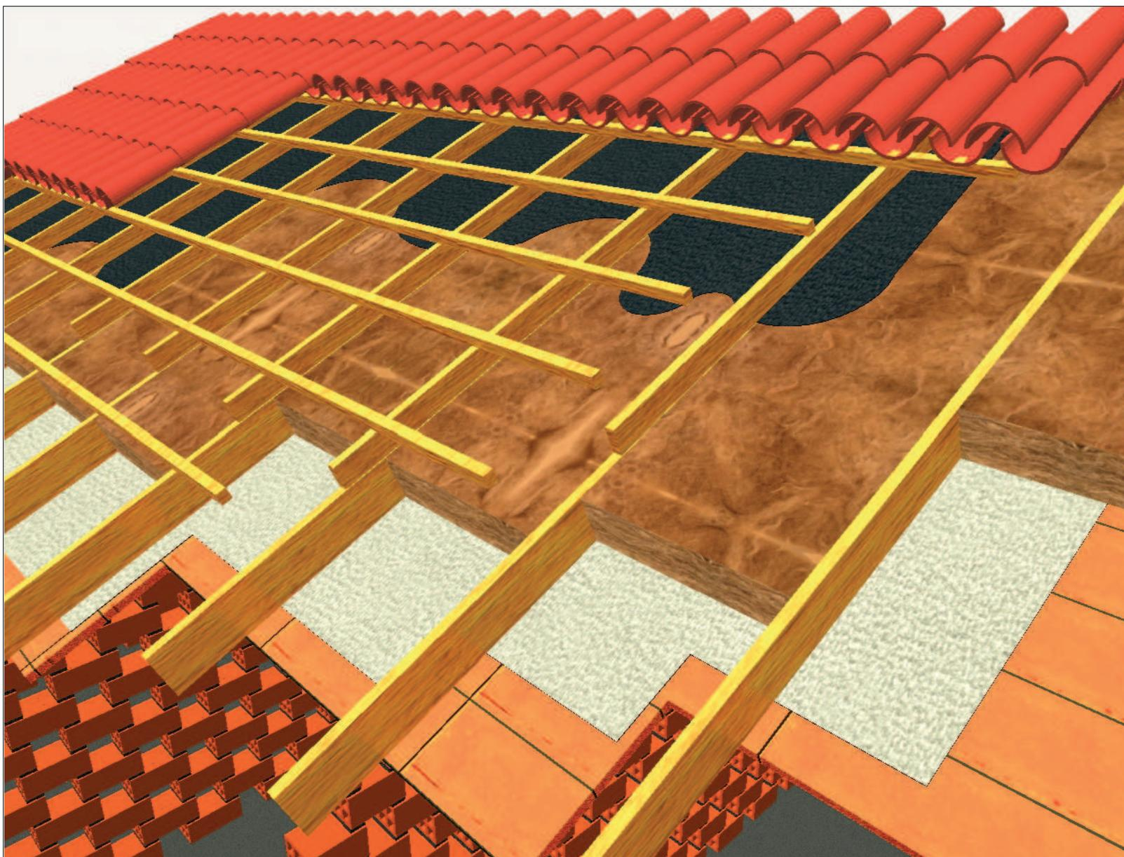
*AISLAMIENTO EXTERIOR DE CUBIERTA INCLINADA CON LANA MINERAL NATURAL PANEL PLUS (TP 138)*
