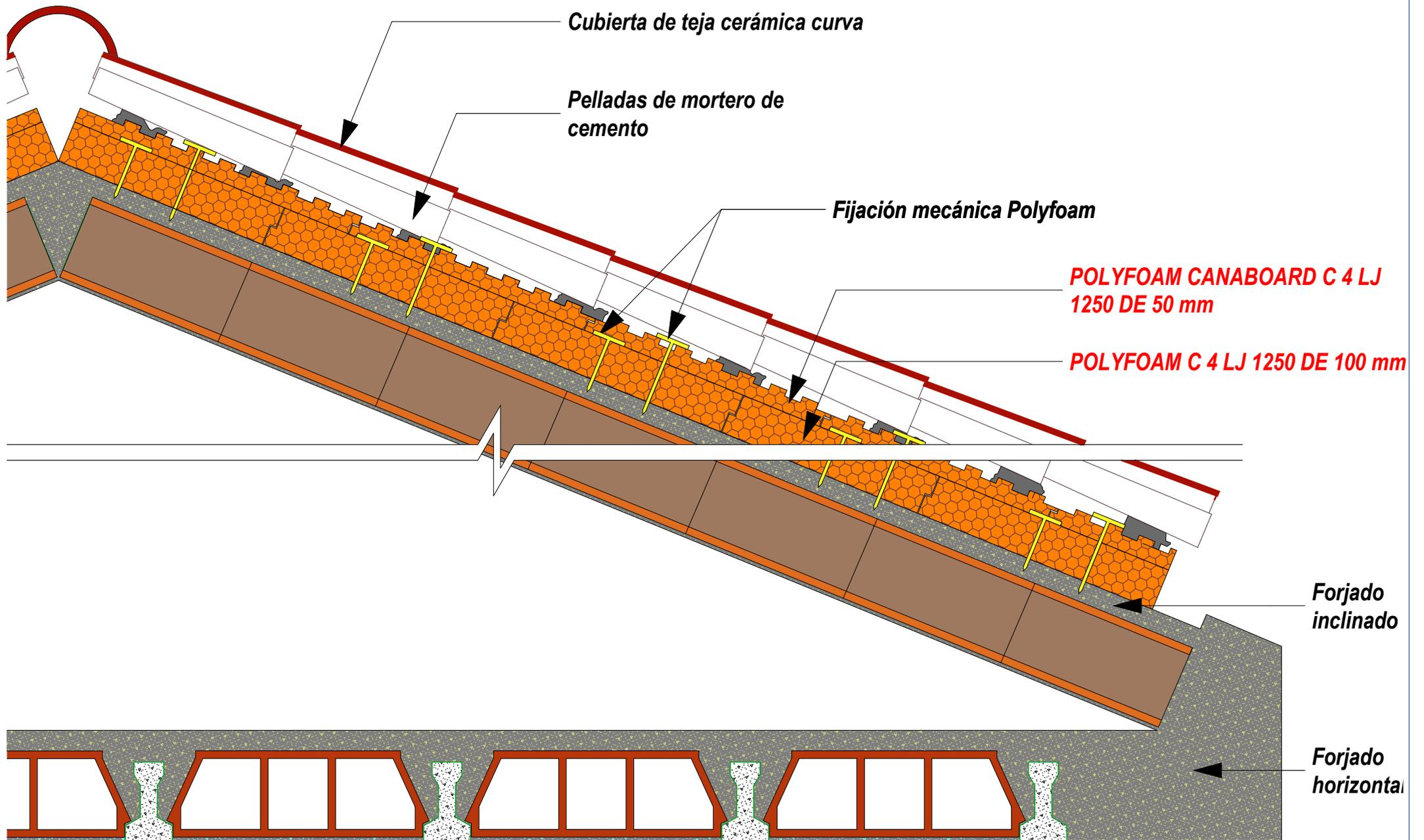
**CUBIERTA INCLINADA SOBRE ESTRUCTURA DE HORMIGON CON POLYFOAM CANABOARD**
