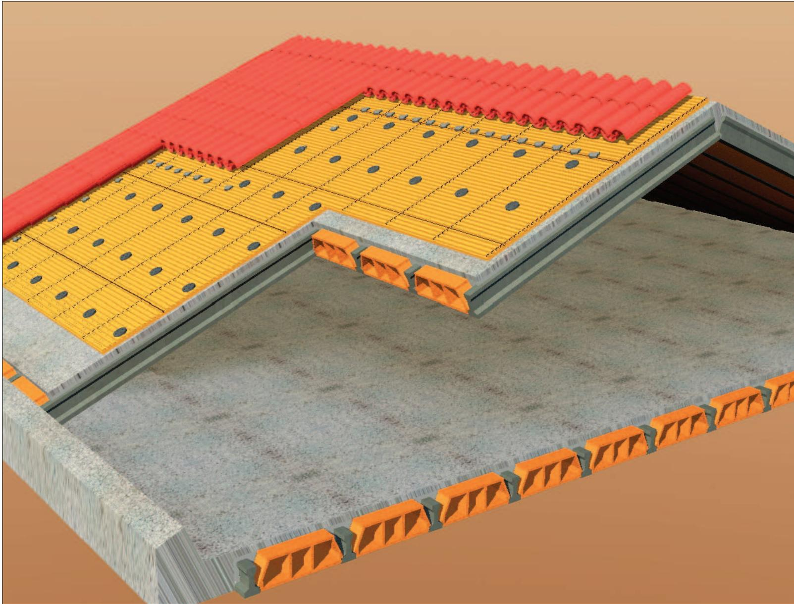
**CUBIERTA INCLINADA SOBRE ESTRUCTURA DE HORMIGON CON POLYFOAM CANABOARD**
