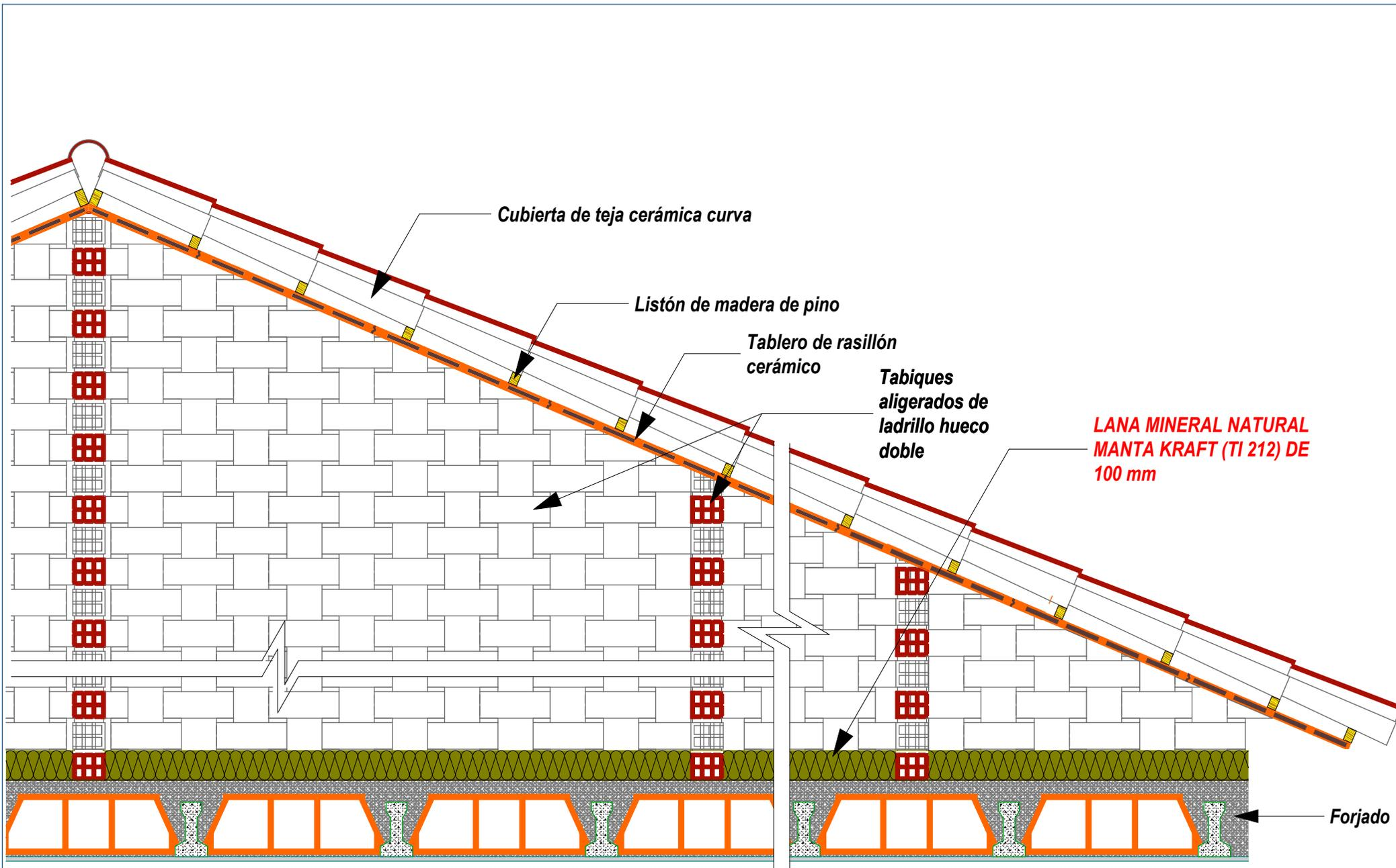
**CUBIERTA INCLINADA SOBRE TABIQUILLOS CON MANTA KRAFT (TI 212)**
