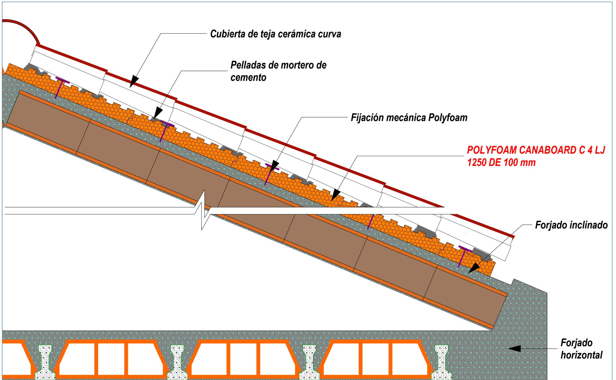
**CUBIERTA INCLINADA SOBRE ESTRUCTURA DE HORMIGON CON POLYFOAM CANABOARD**
