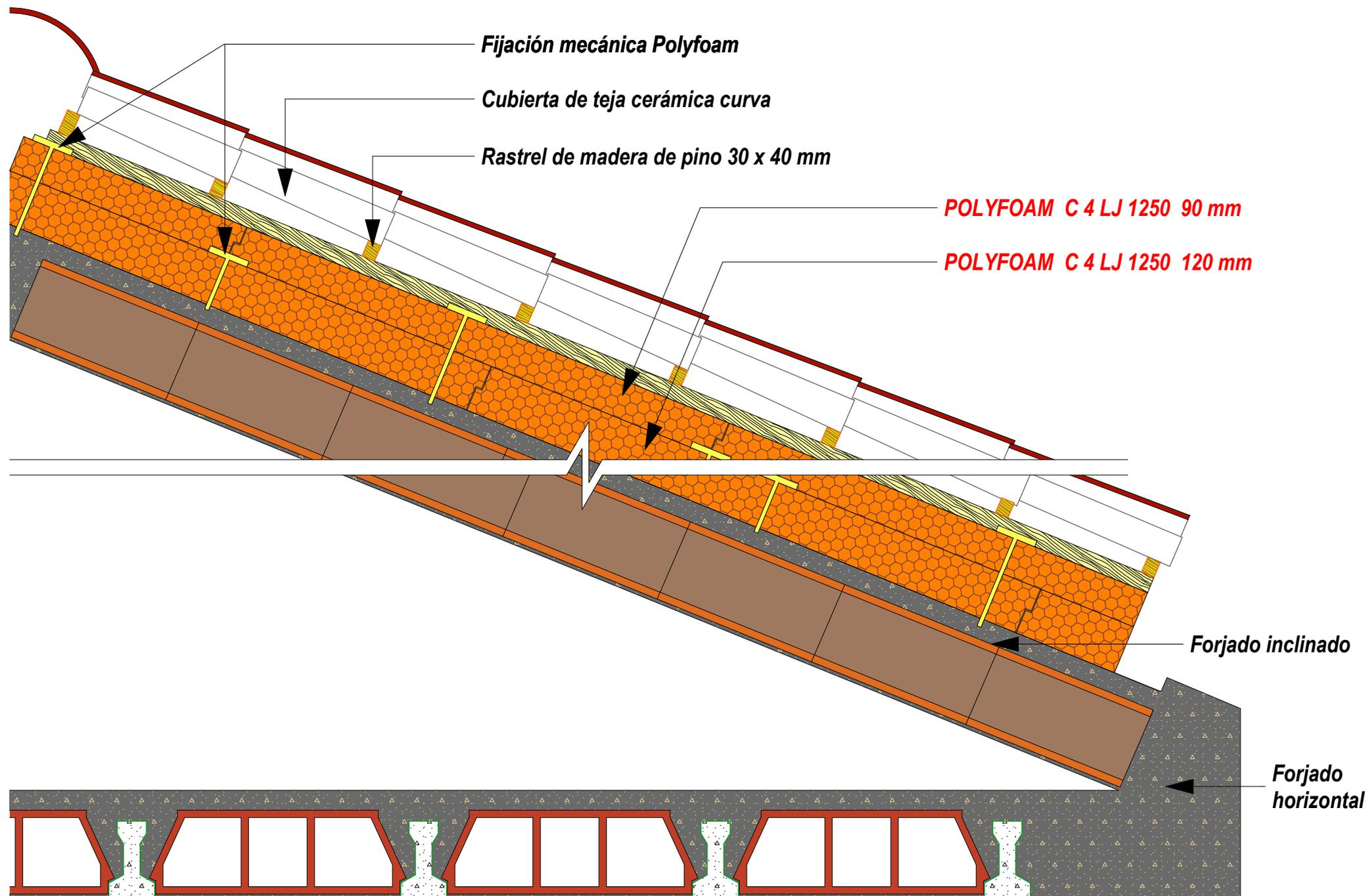
**CUBIERTA INCLINADA CON POLYFOAM C4 LJ 1250 Y COBERTURA CLAVADA**
