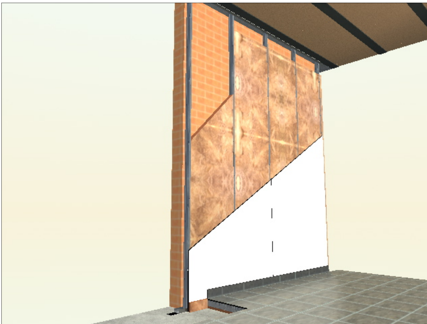
TRASDOSADO CON LANA MINERAL NATURAL PANEL PLUS (TP 138)
